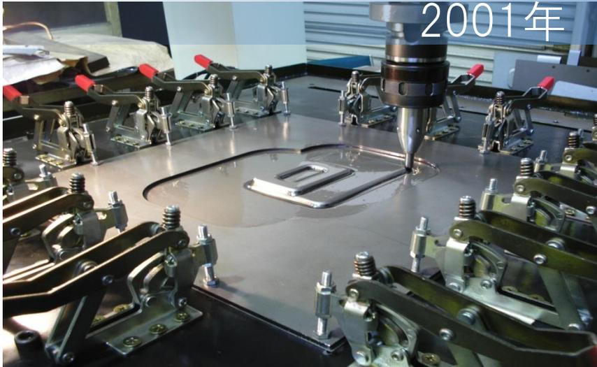
アミノ製ダイレスNCフォーミング機を導入。これによる板金機能の高度化と、積層金型では不可能だった深シボリを実現。
