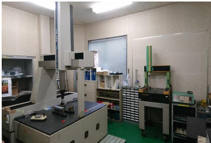
当社では、板金加工会社では珍しい三次元測定機を所有しています。三次元測定機を用いての検査により、加工の際にお客様からお預かりした図面の寸法の規格を満たすだけでなく、測定データも添付し良品とともにお客様の手元にお渡しできる事が可能になりました。
