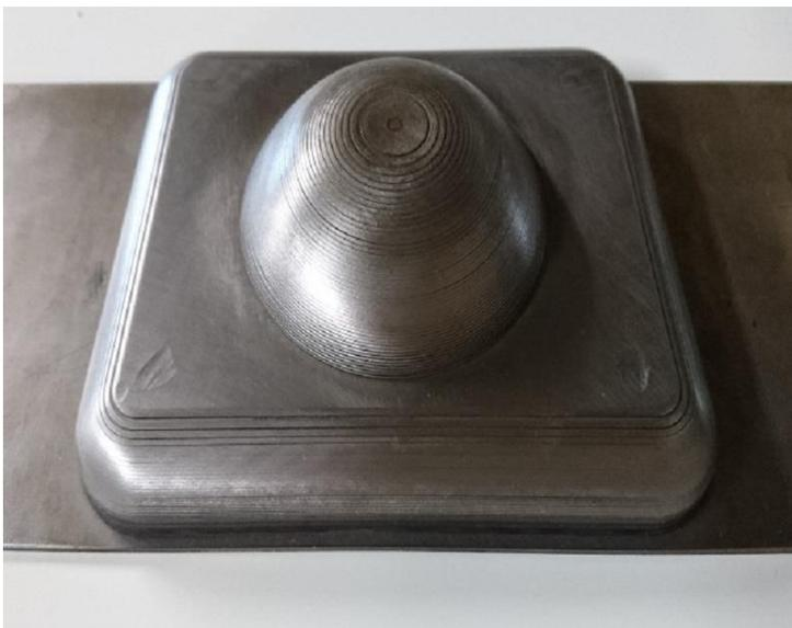
プレス加工で使用する本型の仕組みを応用し、絞りに合わせた凹凸を薄板の積層にて構成した上型・下型の簡易金型による弊社独自のシボリ加工です。
